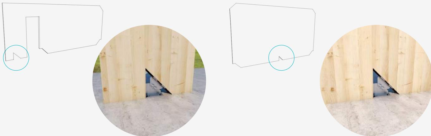
Laddove sia richiesto un fissaggio in fondazione per pareti non strutturali o un fissaggio temporaneo per il corretto allineamento della parete (es. pareti di lunghezza notevole), è possibile installare sull'angolo inferiore del pannello in CLT (con taglio a 45° semplificato senza risega orizzontale) la piastra BEASYT (in alternativa all'X-ONE) e sulla platea di fondazione la piastra BEASYC (in alternativa alle piastre X-PLATE BASE) <sup>(1)</sup>.
