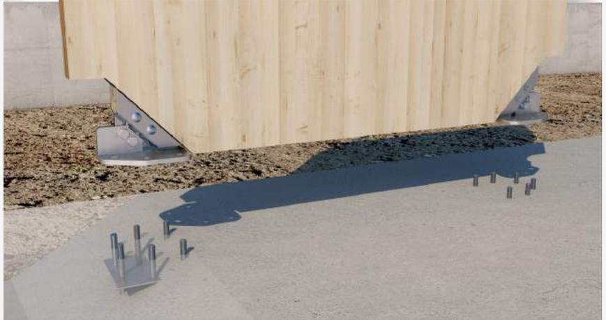
Per garantire un perfetto livellamento, una corretta trasmissione dei carichi verticali e una protezione dall'umidità di risalita dal piano di fondazione si consiglia lo spessoramento delle pareti in CLT e delle piastre X-PLATE di alcuni centimetri e il successivo getto mediante riempimento con malte cementizie strutturali espansive ad elevato grado di impermeabilità.
