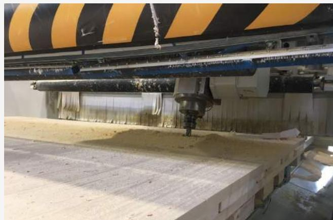
Operazioni di taglio con sega circolare e fresa a candela per la realizzazione della geometria necessaria al posizionamento dell'X-ONE.
