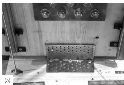
Muestras para las pruebas cíclicas: tracción (a), corte (b) y 45° (c) (fijación parcial).
