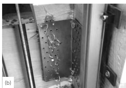
Campioni a fine test ciclici: trazione (a), taglio (b) e 45° (c) (fissaggio parziale).
