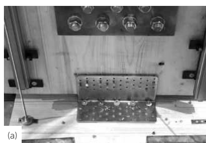
Campioni a fine test ciclici: trazione (a), taglio (b) e 45° (c) (fissaggio parziale).
