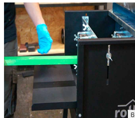
Streichvorgang starten: Düsen öffnen und Rollen mit Farbe vollsaugen lassen. Anschließend Werkstücke durchschieben.
