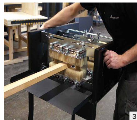
Bürsten an die Dimensionen des Werkstücks anpassen und mit den Schrauben fixieren.
