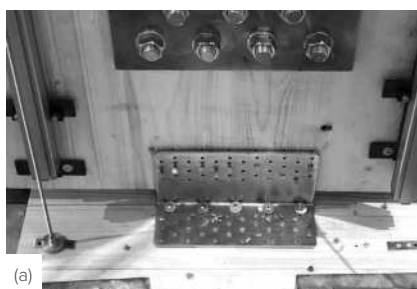
Δείγματα μετά το πέρας των κυκλικών τεστ: εφελκυσμός (α), διάτμηση (β) και 45° (c) (μερική σύνδεση).
