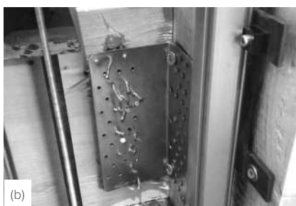
Δείγματα μετά το πέρας των κυκλικών τεστ: εφελκυσμός (α), διάτμηση (β) και 45° (c) (μερική σύνδεση).
