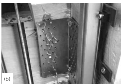
Vzorci ob koncu cikličnih testiranj: natezni (a), strižni (b) in pod kotom 45^\circ (c) (delna pritrditev).
