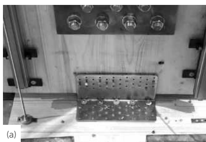
Vzorky na konci opakovaných testov: ťah (a), strih (b) a 45° (c) (čiastočné upevnenie).
