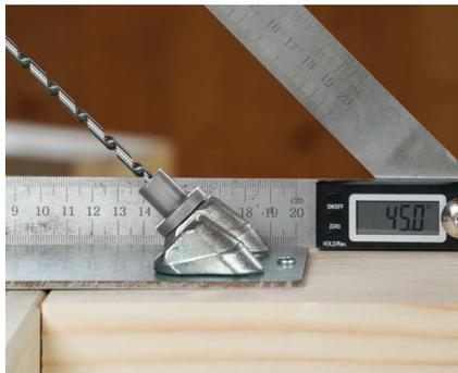
Шаблон JIG VGU позволяет без затруднений выполнять предварительное просверливание отверстий под углом 45°, которые облегчают завинчивание шурупов VGS внутри шайбы. Рекомендуемая глубина предварительно просверленного отверстия составляет не менее 20 мм.
