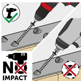
Использование импульсного/ударного шурупверта не допускается.
