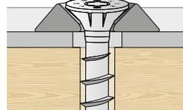
Цилиндрическое отверстие с расширенной шайбой HUS.
