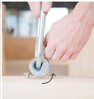
Вставьте шуруп так, чтобы его головка выступала на 15 мм, и зацепите крюк WASPL.
