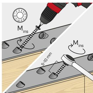
Обеспечивайте правильную затяжку. Рекомендуется использовать шурупверты с регулируемым крутящим моментом, например с TORQUE LIMITER. Можно также выполнять затяжку с помощью динамометрического ключа.
