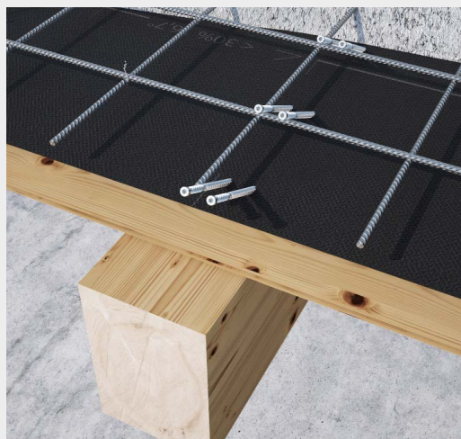
^ Solaio collaborante legno-calcestruzzo con disposizione connettori a 30° su fila doppia.
