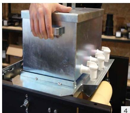
Colocar el depósito de color y asegurarse de que las boquillas estén cerradas. Enganchar el cubo de recogida debajo del depósito.
