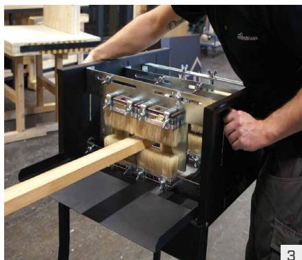
Regular los cepillos en función del elemento y fijarlos apretando los tornillos.
