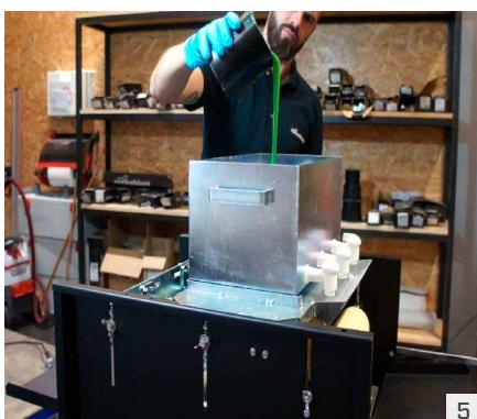
Introducir la pintura o el impregnante. Si es necesario, mezclarlo hasta obtener una consistencia homogénea.
