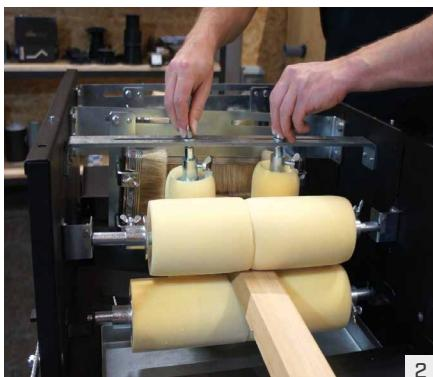
Regular las esponjas en función del elemento y fijarlas apretando con tornillos.
