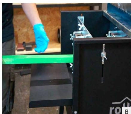
Iniciar el proceso: abrir las boquillas y esperar a que los rodillos absorban el color. Por último, empujar los elementos a través de las esponjas.
