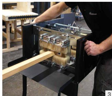
Adapter les balais aux dimensions de l'élément et les fixer en serrant les vis.
