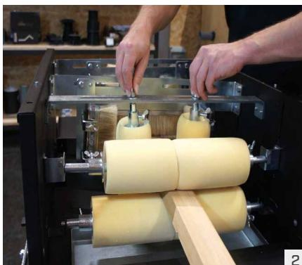
Adapter les éponges aux dimensions de l'élément et les fixer en serrant les vis.
