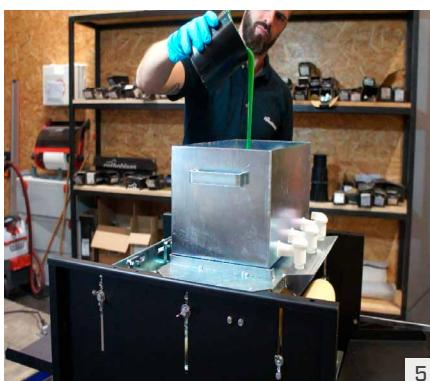
Verser la peinture ou le produit d'imprégnation. Si nécessaire, mélanger jusqu'à obtenir une consistance homogène.
