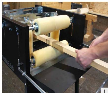
Insérer l'élément entre les deux endui-seuses automatiques.
