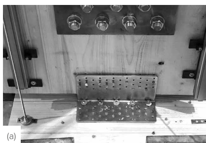
Образцы по окончании циклического испытания: отрыв (a), сдвиг (b) и 45° (c) (частичное крепление).
