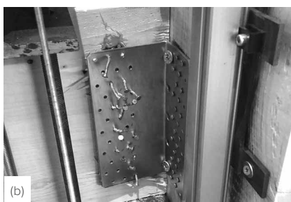
Образцы по окончании циклического испытания: отрыв (a), сдвиг (b) и 45° (c) (частичное крепление).
