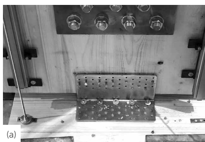
Uzorci na kraju cikličkog ispitivanja: vuča (a), smicanje (b) i 45 ° (c) (djelomično pričvršćivanje).
