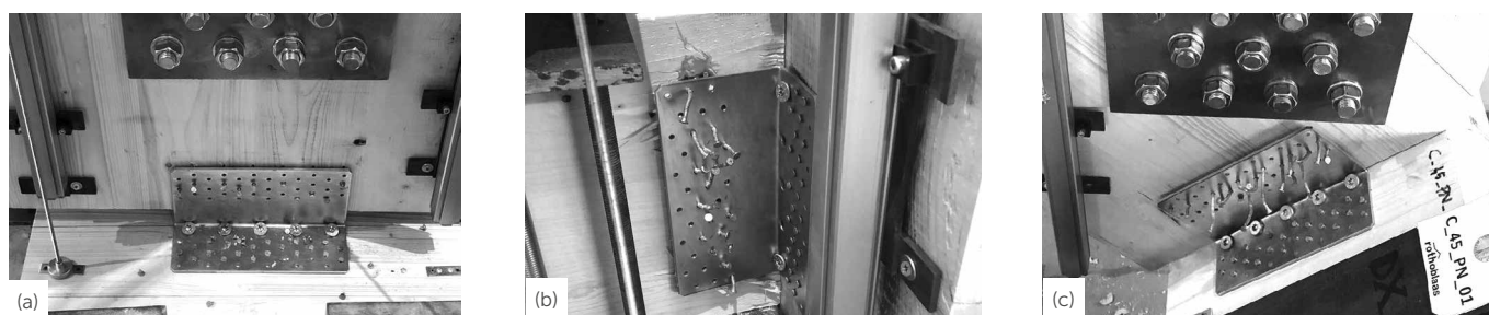
Échantillons à la fin des tests cycliques : traction (a), cisaillement (b) et 45° (c) (fixation partielle).
