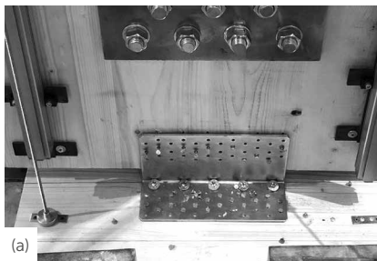
Proben am Ende der zyklischen Tests: Zug (a), Scherung (b) und 45° (c) (Teilausnagelung).
