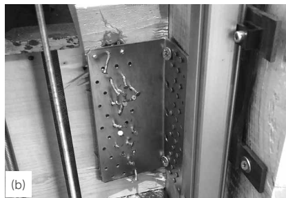
Proben am Ende der zyklischen Tests: Zug (a), Scherung (b) und 45° (c) (Teilausnagelung).
