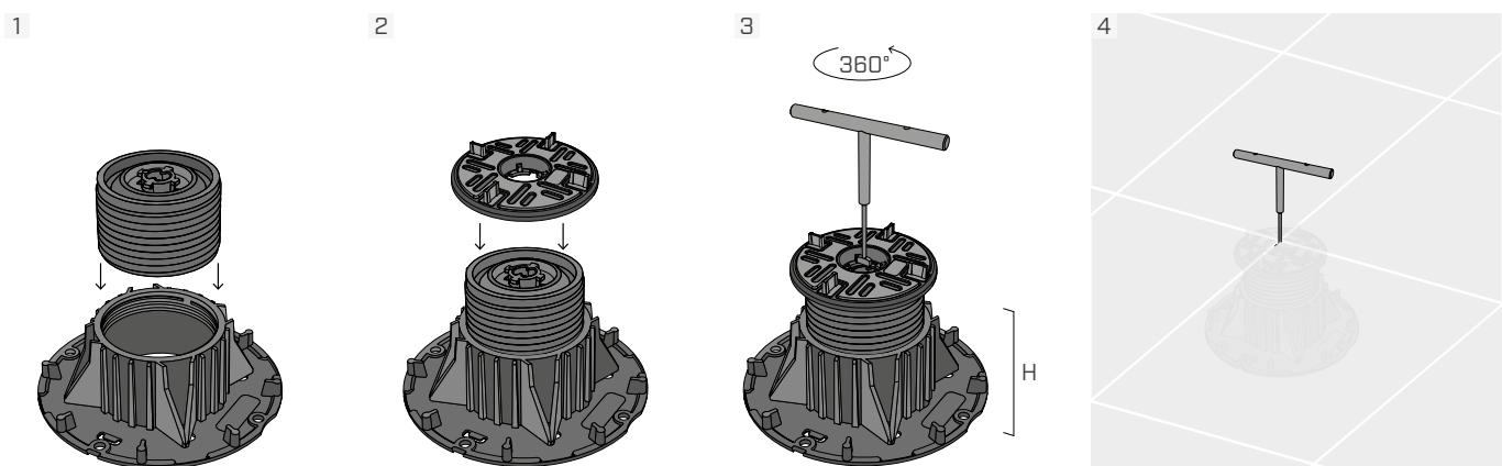
将 SUPLHEAD3 小头放在 SUP-L 上。使用 SUPLKEY 调整支架高度。将瓷砖放在支架上。通过使用 SUPLKEY 从上方调整支撑高度来平整地板，而无需移除已经铺设的瓷砖。摇杆头可以在铺陈过程中进行坡度高达 5% 的自调平。
