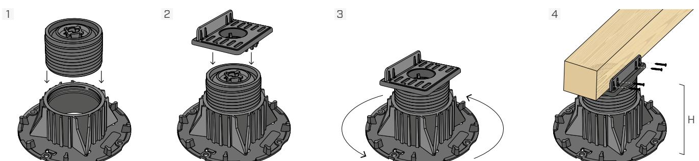
将 SUPLHEAD1 小头安装到 SUP-L 上，根据需要调节高度，并用直径为 4.5 mm 的 KKF 螺钉横向固定板条。摇杆头可以在铺陈过程中进行坡度高达 5% 的自调平。
