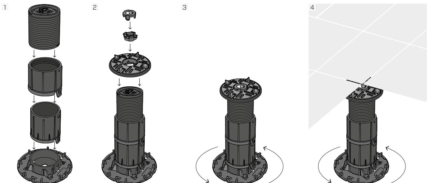
如有，请将 SUPLEXTE100 延长件添加到 SUP-L 支架上，然后安装 SUPLHEAD3 小头。要避免自调平头倾斜，请使用 SUPLRING1 将其固定。放置 SUPLRING2。根据需求调整高度，并定位地板。
