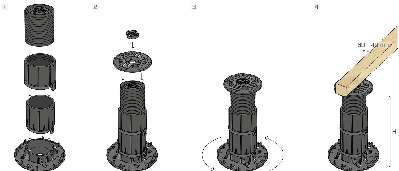
如有, 请将 SUPLEX100 延长件添加到 SUP-L 支架上, 然后安装 SUPLHEAD2 小头。要阻止自调平头倾斜, 请使用 SUPLRING1 将其固定。根据需求调整高度, 并将板条放在挡翼内。
