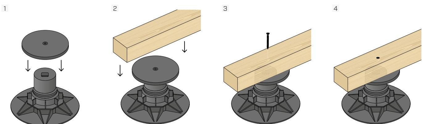
将 SUPMHEAD1 小头安装到 SUP-M 上，并用直径为 4.5 mm 的 KKF 螺钉固定板条。
