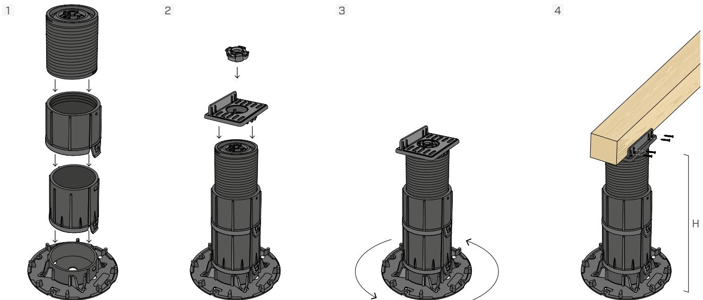
如有, 请将 SUPLEX100 延长件添加到 SUP-L 支架上, 然后安装 SUPLHEAD1 小头。要阻止自调平头倾斜, 请使用 SUPLRING1 将其固定。根据需要调节高度, 并用直径为 4.5 mm 的 KKF 螺钉侧向固定板条。
