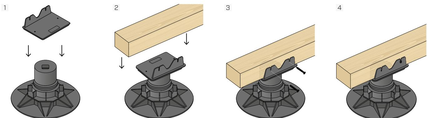
将 SUPMHEAD2 小头安装到 SUP-M 上，并用直径为 4.5 mm 的 KKF 螺钉横向固定板条。
