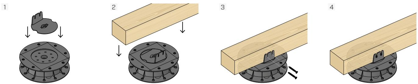
将 SUPSLHEAD1 小头安装到 SUP-S 上，并用直径为 4.5 mm 的 KKF 螺钉固定板条。
