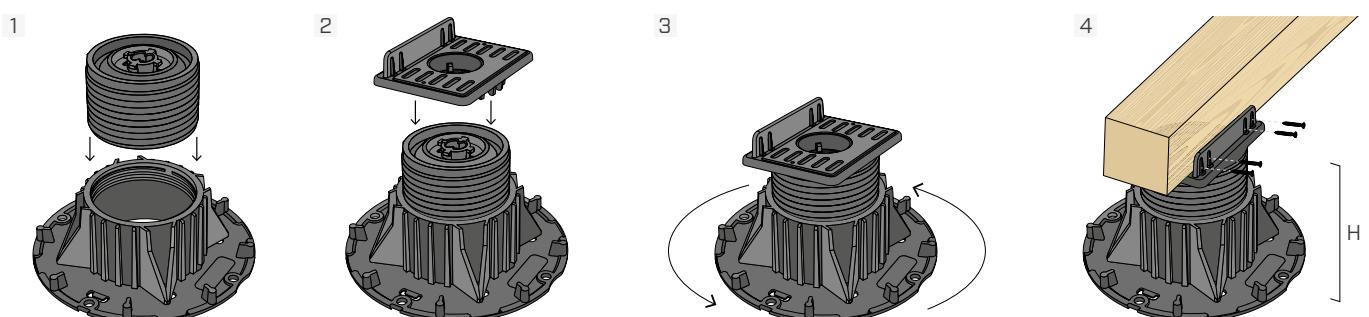
Encastrar a cabeça SUPLHEAD1 no SUP-L, regular a altura em base às exigências e fixar a ripa lateralmente com parafusos KKF diâmetro 4,5 mm. A cabeça basculante permite o autonivelamento durante a colocação em inclinações até 5%.
