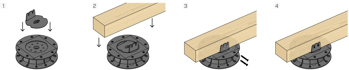
Encastrar a cabeça SUPSLHEAD1 no SUP-S e fixar a ripa com parafusos KKF diâmetro 4,5 mm.
