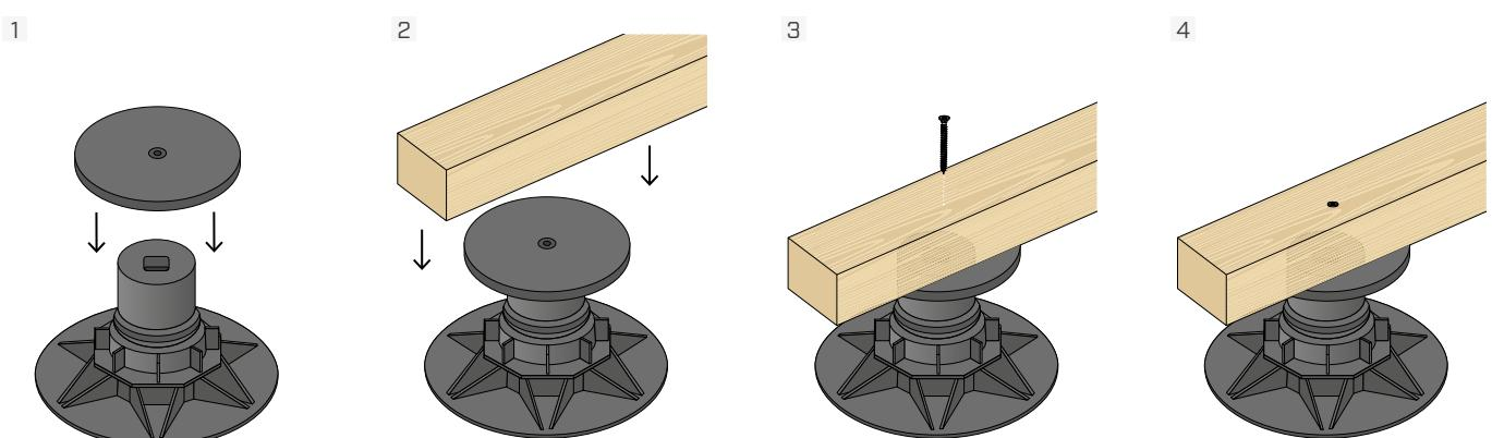
Encastrar a cabeça SUPMHEAD1 no SUP-M e fixar a ripa com parafusos KKF diâmetro 4,5 mm.
