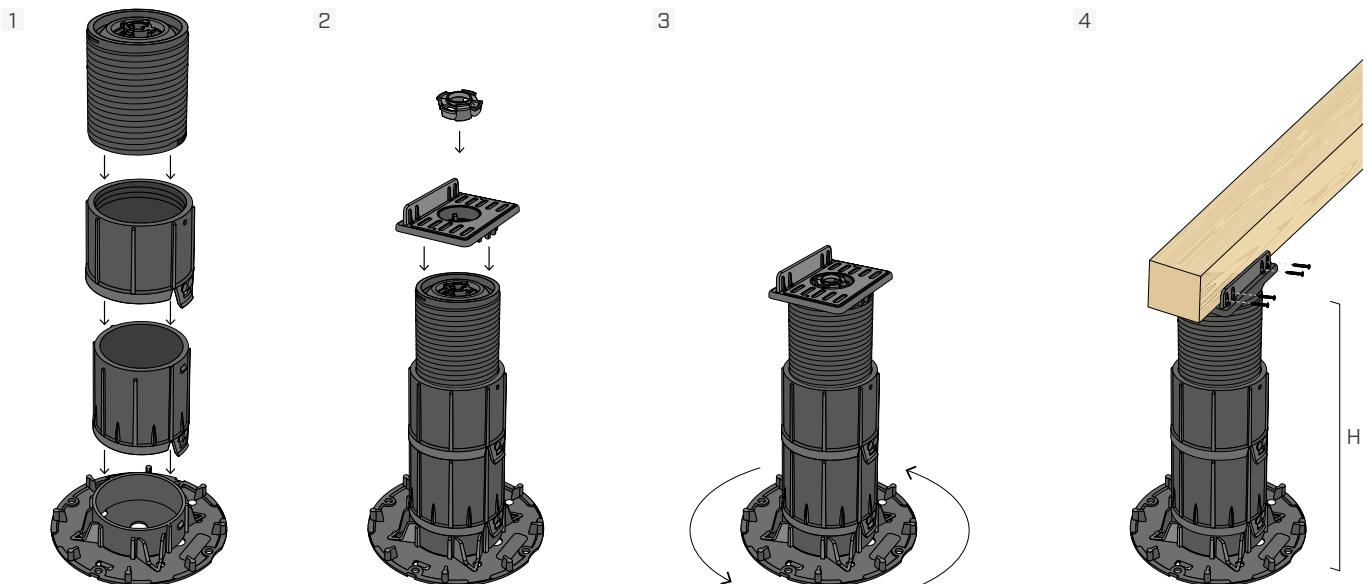
Se prevista, adicionar a extensão SUPLEX100 ao suporte SUP-L e posteriormente encastrar a cabeça SUPLHEAD1. Para bloquear o basculamento da cabeça autonivelante, fixá-la com o SUPLRING1. Ajustar a altura em base às exigências e fixar a ripa lateralmente com parafusos KKF diâmetro 4,5 mm.
