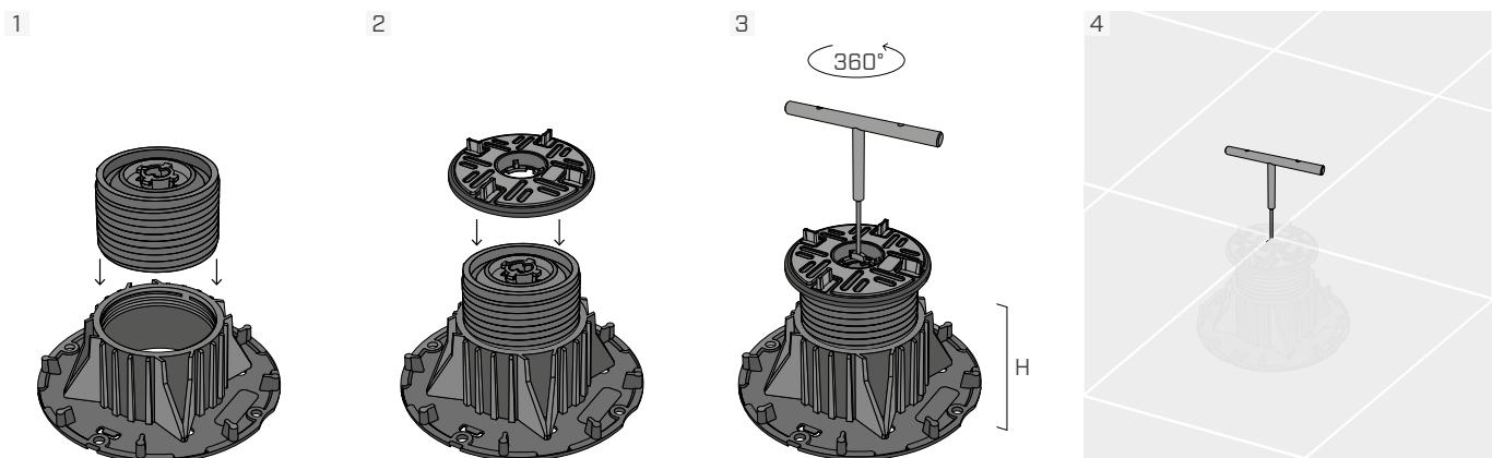
Encastrar a cabeça SUPLHEAD3 no SUP-L. Ajustar a altura do suporte utilizando o SUPLKEY. Colocar os ladrilhos nos suportes. Nivelar o pavimento ajustando a altura dos suportes a partir de cima com o SUPLKEY sem ter de remover os ladrilhos já colocados. A cabeça basculante permite o autonivelamento durante a colocação em inclinações até 5%.
