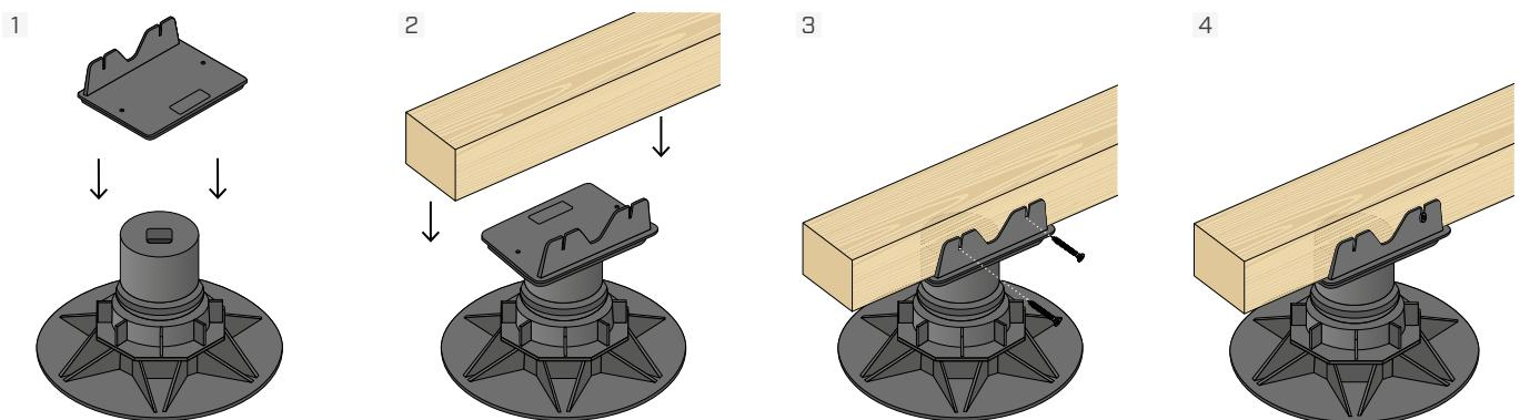
Encastrar a cabeça SUPMHEAD2 no SUP-M e fixar a ripa lateralmente com parafusos KKF diâmetro 4,5 mm.
