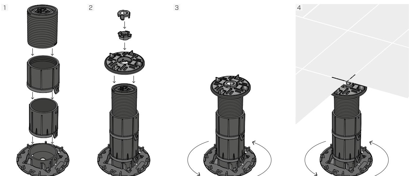
Adicionar, se prevista, a extensão SUPLEX100 ao suporte SUP-L e posteriormente encastrar a cabeça SUPLHEAD3. Para bloquear o basculamento da cabeça autonivelante, fixá-la com o SUPLRING1. Colocar o SUPLRING2. Ajustar a altura conforme necessário e assentar o pavimento.
