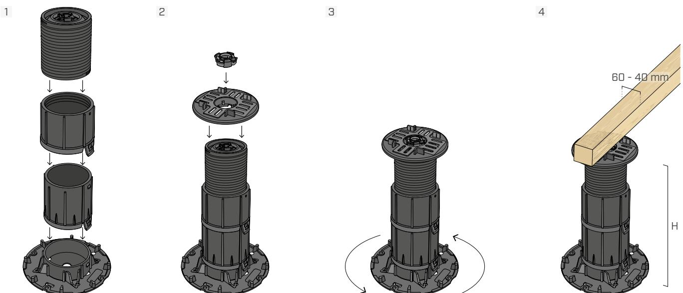
Se previstas, adicionar as extensões SUPLEX100 ao suporte SUP-L e posteriormente encastrar a cabeça SUPLHEAD2. Para bloquear o basculamento da cabeça autonivelante, fixá-la com o SUPLRING1. Ajustar a altura conforme necessário e colocar a ripa dentro das aletas.
