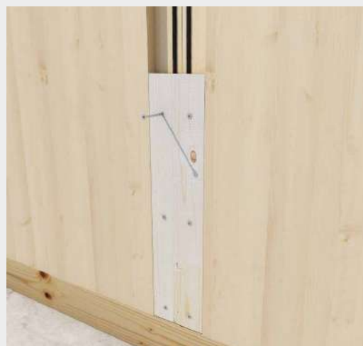
Fixovanie stien z CLT so skrutkami HBS s priemerom 6 mm.
