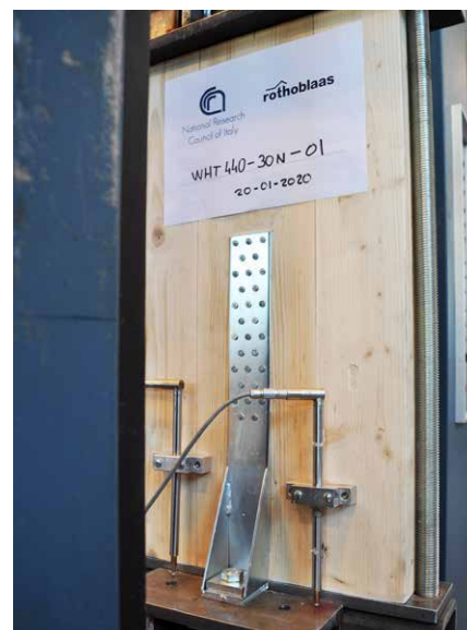
Экспериментальная кампания по панелям CLT (C24) (CNR-IBE Сан-Микеле-аль-Адидже, 2020).
